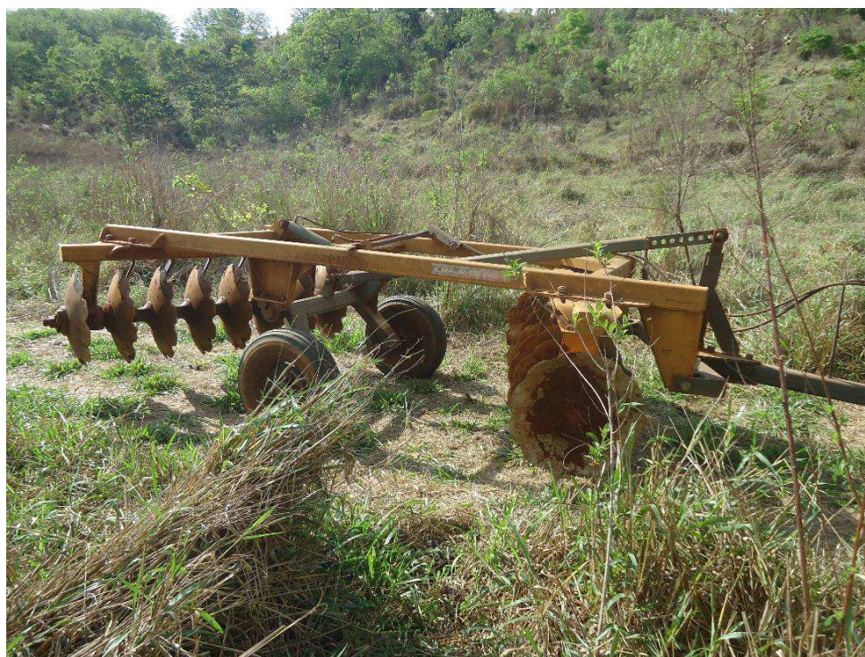
Figura 6: Grade aradora de 16 discos utilizada no preparo do solo.
