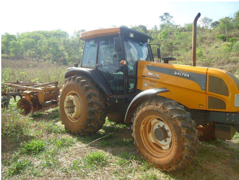
Figura 5: Trator com grade aradora utilizado para o preparo do solo.
