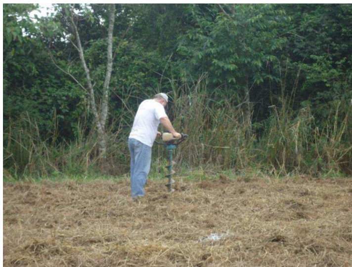
Figura 15: Operação do perfurador manual de solo.
