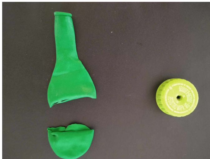
Fig. 7: Recorte feito em um Balão de Borracha e Furo feito na Tampa da Garrafa.
