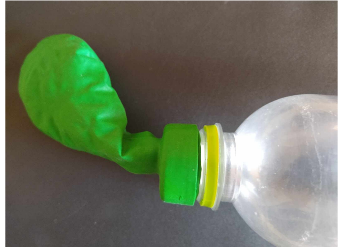
Fig.11: O Segundo Balão é colocado por Cima da Válvula feita na Tampa
