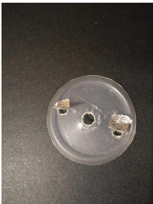
Fig. 5: Válvulas feitas no recorte do Fundo do Pote de Plástico.
