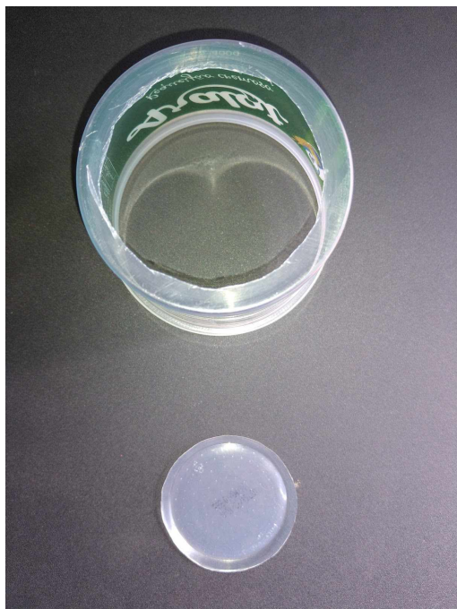
Fig. 3: Recorte feito no Fundo do Pote, parte retirada têm 6 cm de diâmetro
