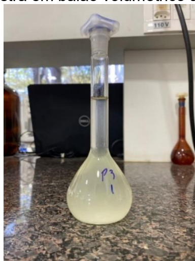
Figura 15: Amostra em balão volumétrico após a digestão.
