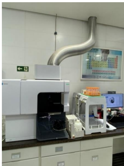
Figura 16: Equipamento ICP - Espectrometria de massa por plasma
