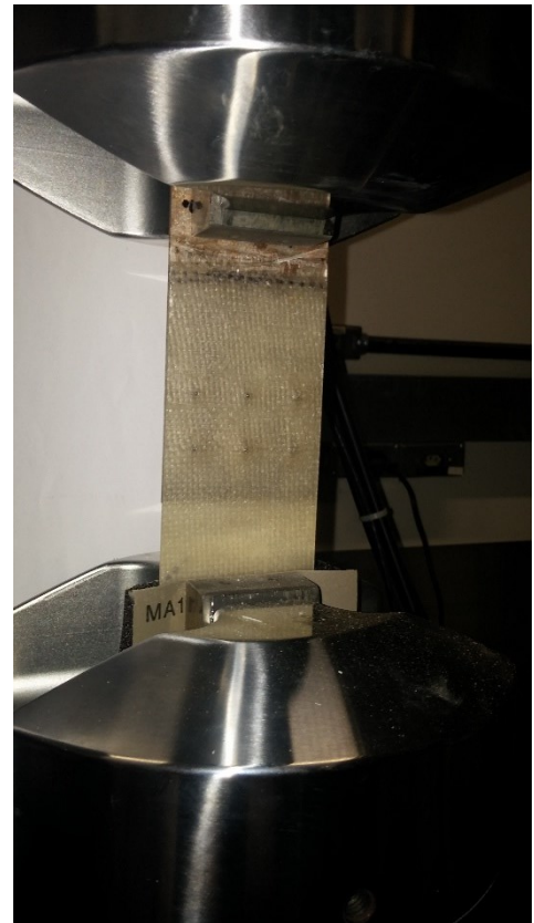
Figura 40 - Vista global do CP preso às garras hidráulicas da máquina de tração. Fonte: autoria própria.
