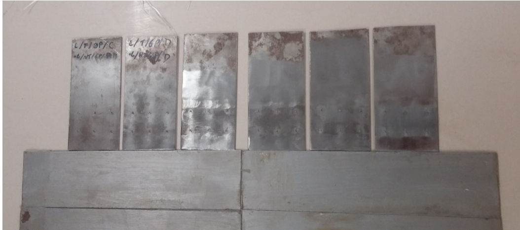
Figura 31 – Chapas posicionadas e prontas para a laminação. Fonte: Lucas Carnio (2017)
