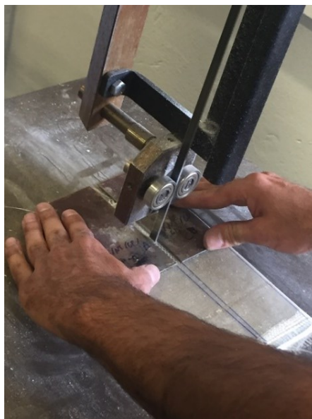
Figura 35 – Separação dos CP's utilizando serra de fita. Fonte: autoria própria.
