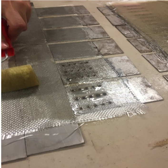
Figura 32 – Rolo de poliéster auxiliando na distribuição da resina e envolvimento das fibras em torno dos pinos. Fonte: autoria própria.
