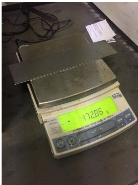
Figura 22 – Balança utilizada para medição de massa de todas as chapas. Fonte: autoria própria.
