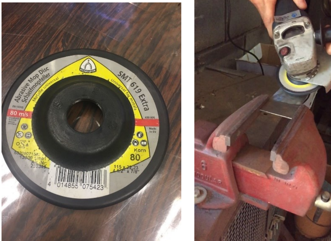
Figura 23 - Disco de lixa utilizado e tratamento superficial sendo realizado em uma chapa de aço 1020. Fonte: autoria própria.
