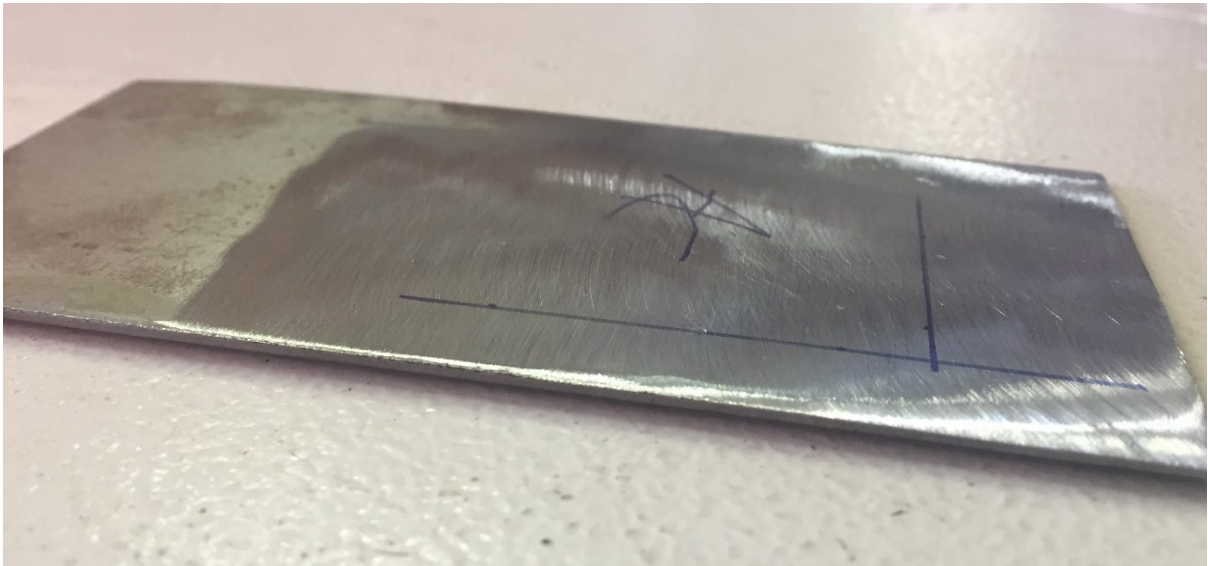
Figura 24 - Detalhe da chapa de aço 1020 após processo de tratamento superficial. Os traços em azul foram feitos para referência da programação geométrica do robô. Fonte: autoria própria.
