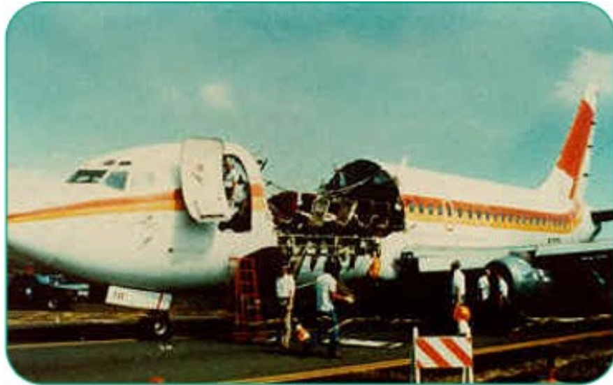
Figura 1 – Vista de um Boeing 737 após acidente causado por concentração de trincas estruturais em juntas rebetadas. Fonte: FAA NTSB/AAR-89/03 report (2016).
