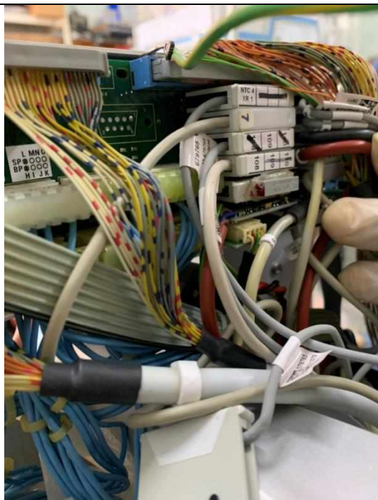
Figura 36 - Resistores 56 e 104 ohms no pino x 13
