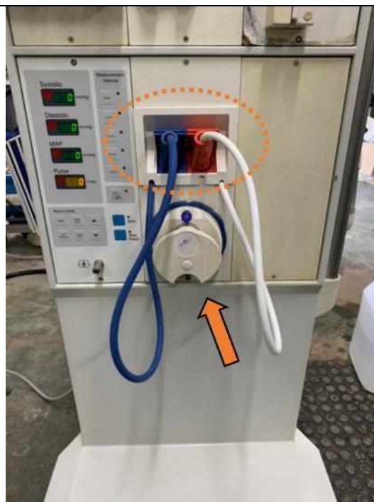
Figura 6 - Ponteiras na câmara de lavagem
