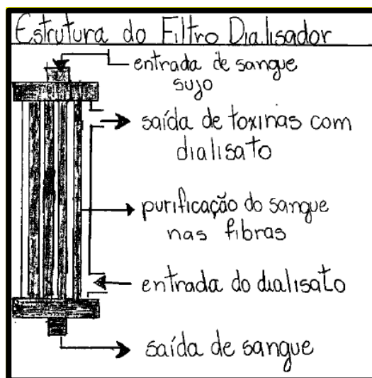
Figura 2.6: Estrutura do Filtro Dialisador
