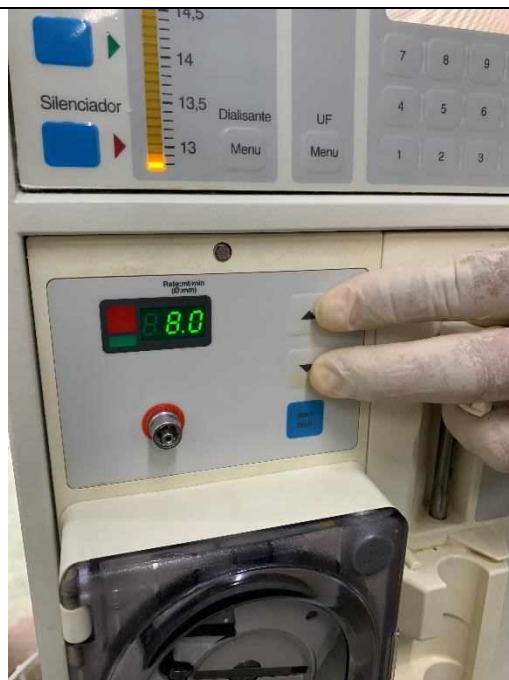
Figura 42 - Teclas para cima e para baixo simultaneamente
