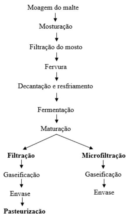
Figura 2 - Fluxograma da produção de cerveja pasteurizada e microfiltrada
