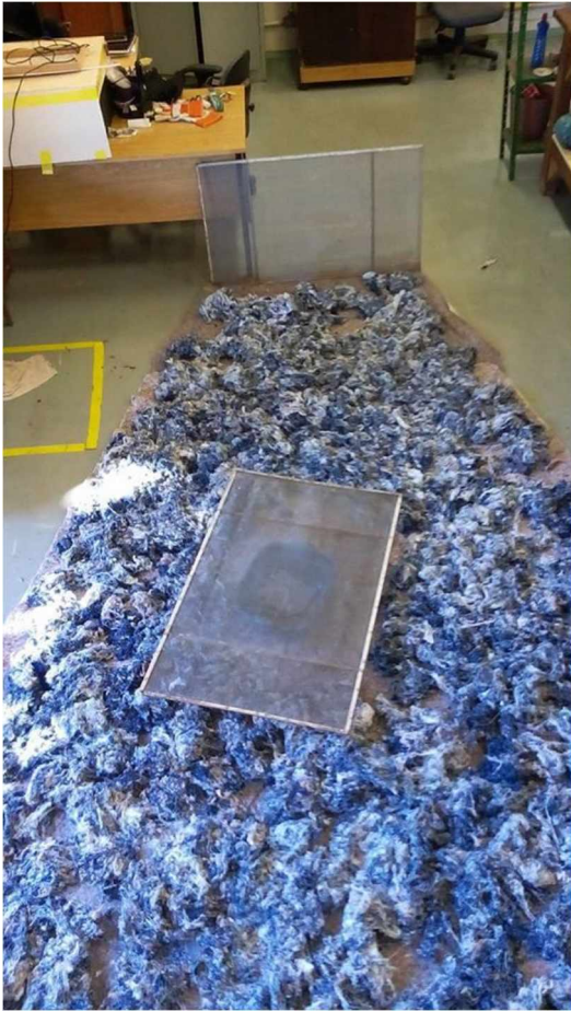
Figura 2 - Tapete de Estopas concluído.
