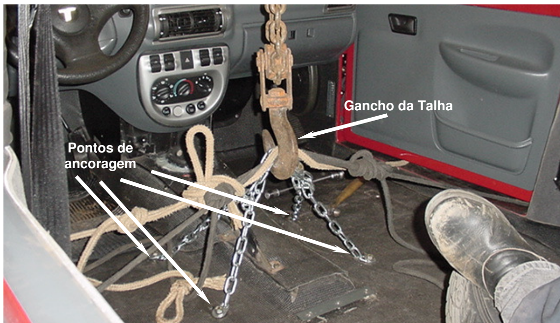
Figura 6.9: Montagem para separação da carroceria do chassi.
