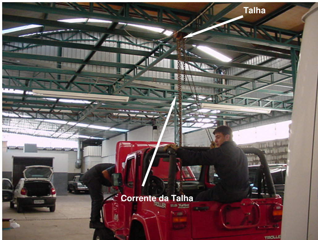
Figura 6.8: Fixação da Talha à estrutura metálica do galpão.
