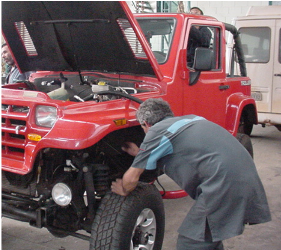
Figura 6.11: Inspeção antes da retirada da carroceria.
