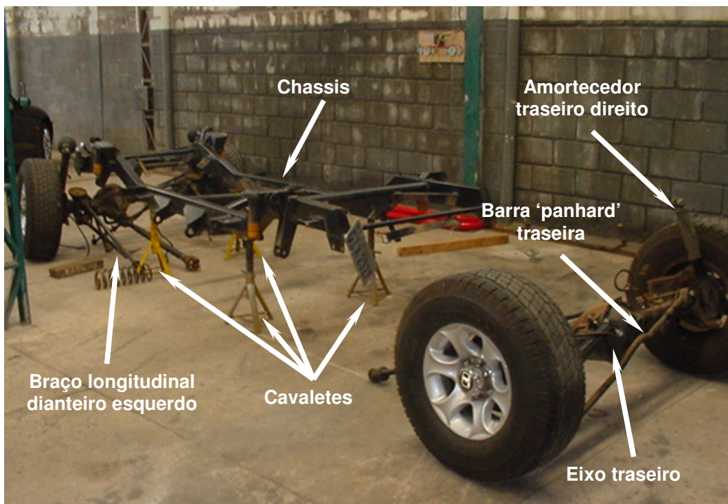
Figura 6.23: Chassis apoiado em cavaletes e eixo traseiro já removido.
