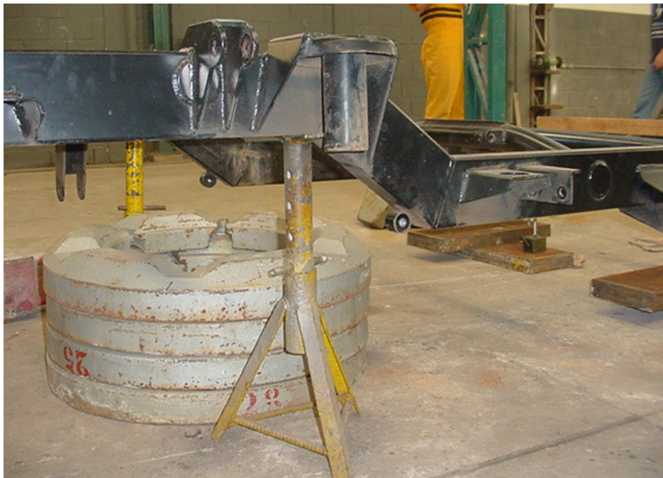
Figura 6.44: Detalhe do apoio na traseira da estrutura.
