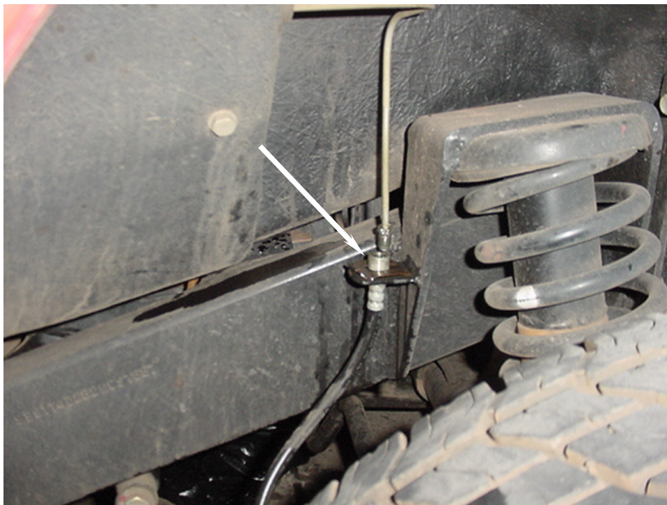
Figura 6.6: Tubulação de fluido do freio dianteiro direito desconectada.
