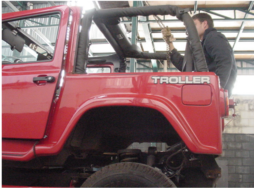
Figura 6.10: Carroceria separada do chassi e pronta para inspeção.
