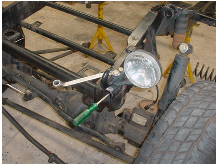
Figura 6.24: Retirada dos acessórios que não pertencem à estrutura do chassi.
