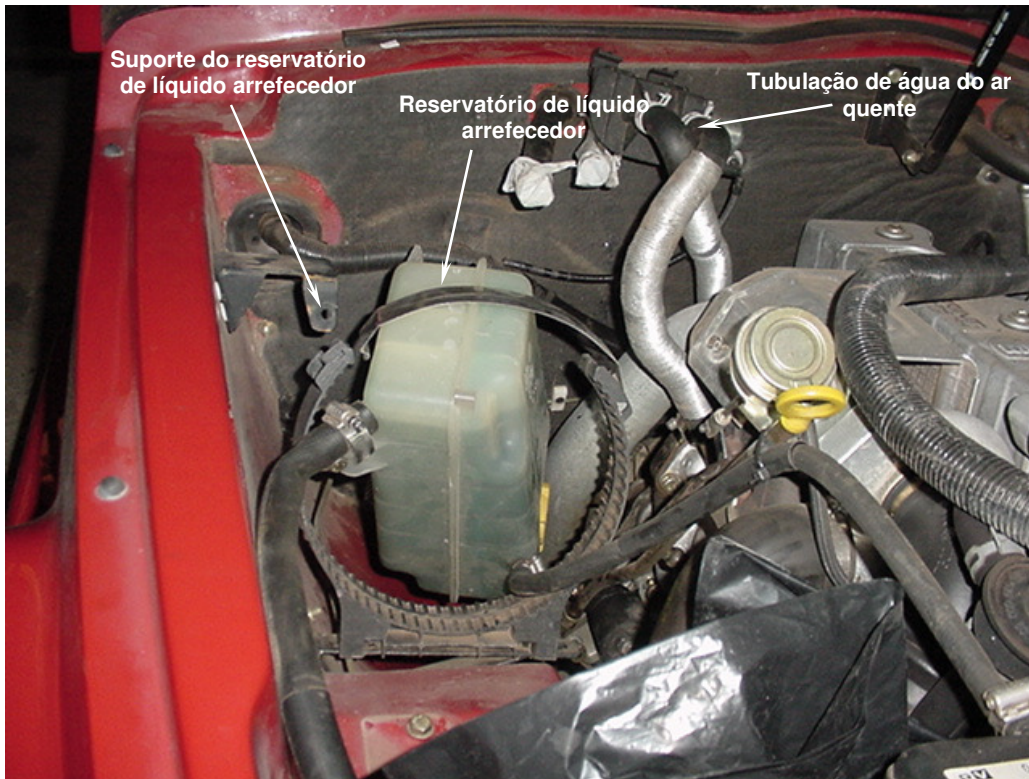
Figura 6.5: Retirada do reservatório do líquido arrefecedor de seu suporte e desconexão das tubulações de água do aquecedor de ar.
