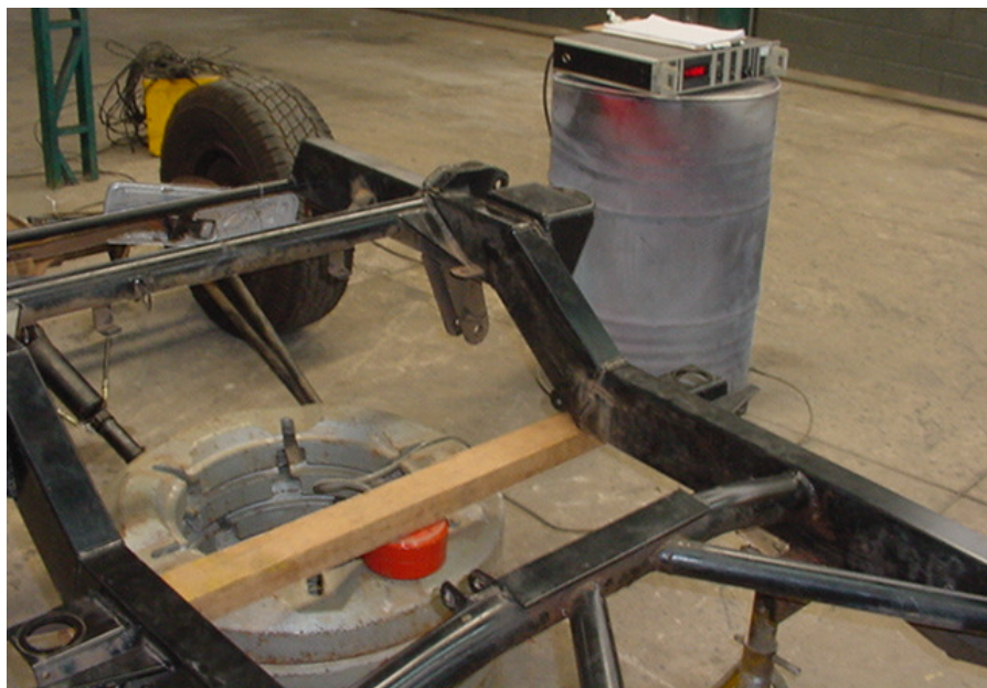
Figura 6.60: Detalhe da travessa usada para permitir o apoio da célula de carga.
