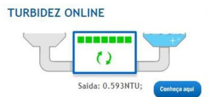
Figura 8 – Turbidez após a filtração ETA Renato de Freitas.
