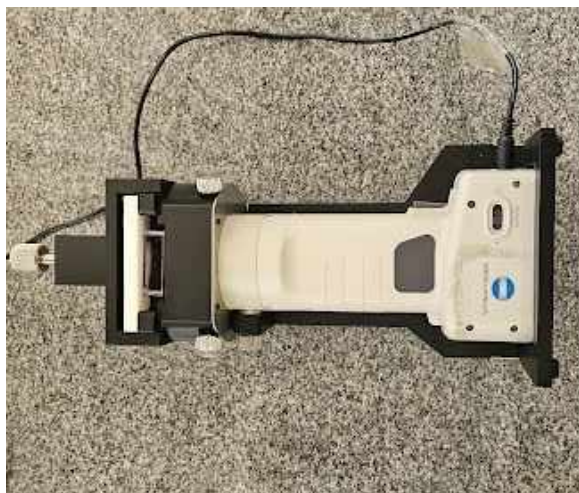
Figura 14 – Colorímetro analisando amostra in natura .
