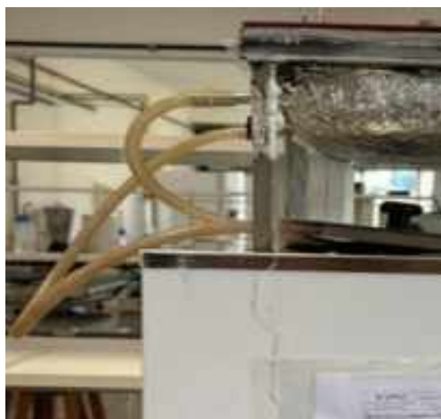
Figura 10– Entrada e saída de água no secador.
