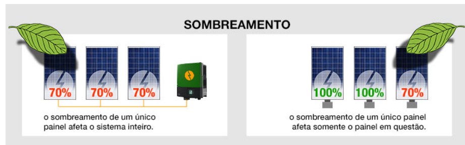
Figura 24: Diferença de efeito de sombreamento entre sistema com inversores string e microinversores.
