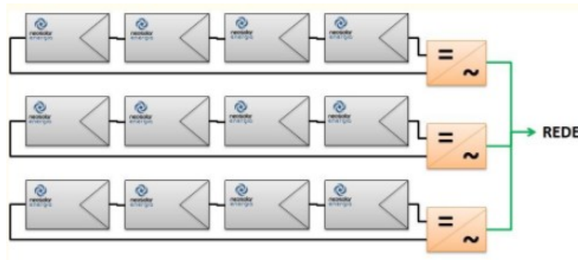
Figura 18: ConFiguração de um SFCR com inversor String .
