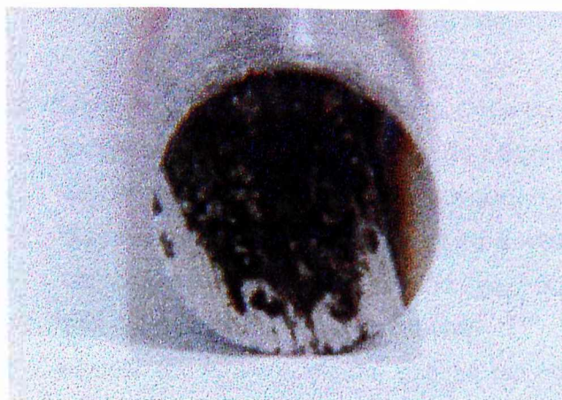
Figura 4.12 – Detalhe da superfície após sofrer descargas elétricas em condições mais agressivas de usinagem por ECG
