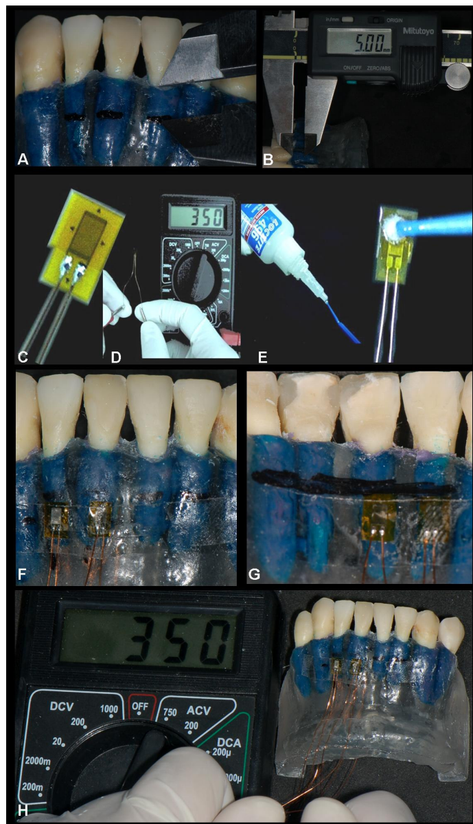
Figura 9. A- simulação da altura da perda óssea; B- 5 mm da margem da resina de poliestireno até a linha demarcada; C- extensômetro utilizado na fixação; D- mensuração da resistência elétrica; E- cola de cianoacrilato para fixação e aplicada no extensômetro; F- dois extensômetros aderidos na face vestibular, nas regiões de IC e IL direitos; G- dois extensômetros aderidos na face lingual, nas regiões de IC e IL direitos; H- mensuração da resistência após colagem dos extensômetros.
