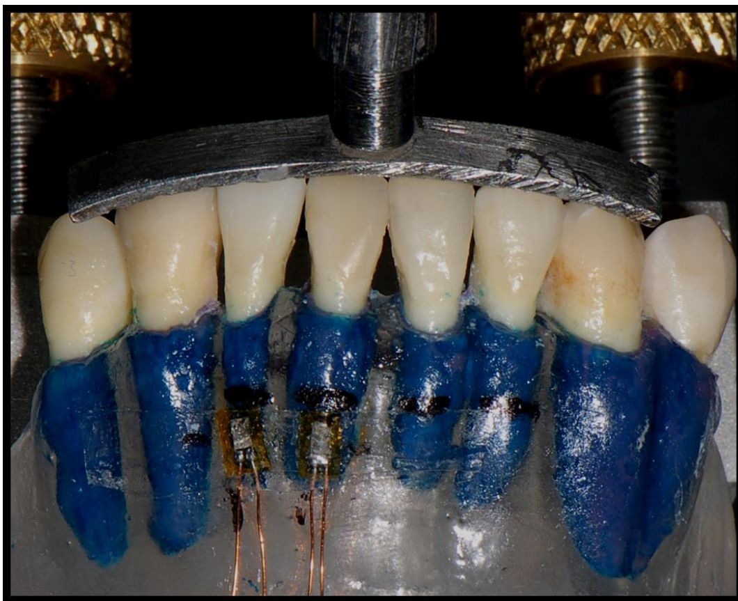
Figura 12. Dispositivo para carregamento posicionado na porção incisal vestibular dos incisivos e caninos inferiores.
