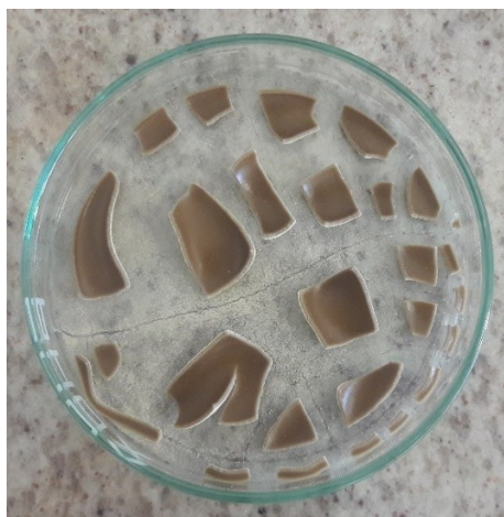
Figura 25. Filme com a enzima imobilizada utilizando o OC2 como suporte.
