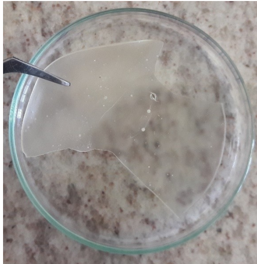
Figura 16. Filme padrão de Octanoato de Celulose.
