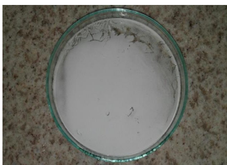
Figura 8. Produto da síntese de octanoato de celulose (OC1).
