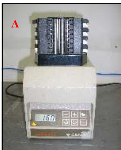
Figura 29 – Equipamentos do sistema em fluxo: A- Bomba peristáltica; B-Injetor comutador de geometria circular.
