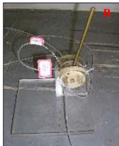
Figura 29 – Equipamentos do sistema em fluxo: A- Bomba peristáltica; B-Injetor comutador de geometria circular.
