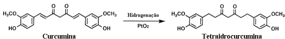
Figura 2: Preparação de tetraidrocurcumina a partir da curcumina por hidrogenação com \text{PtO}_2 .
