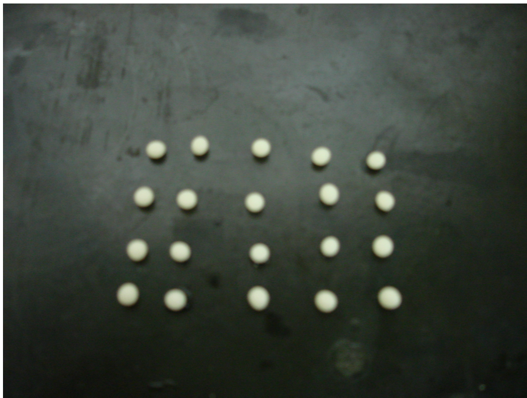
Figura 3.5 – Partículas com biocatalisador imobilizado.
