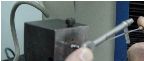
Figura 5 – Sistema implante, pilar e parafuso recebendo torque de 20N
