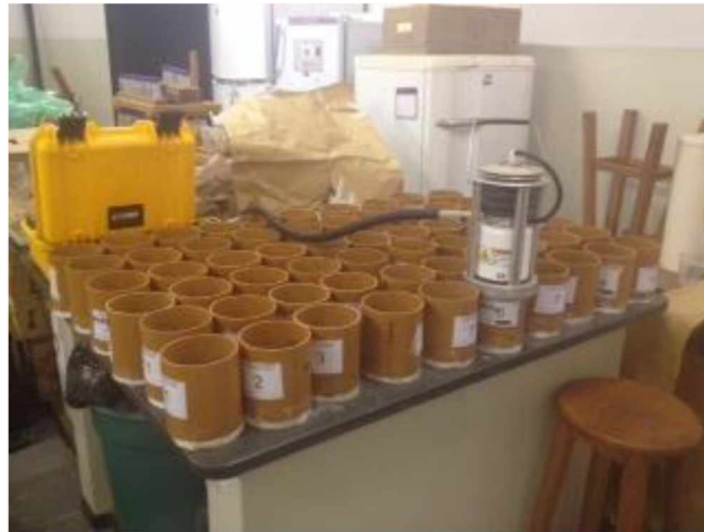
Figura 3: Vasos de PVC com base de isopor para acondicionamento dos solos (BORGES, M.F.)
