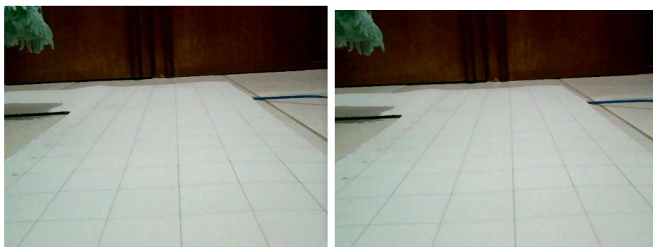
Figura 10 – Imagem do robô visualizando a grade de calibração. (a) Imagem sem tratamento, (b) Imagem com distorção corrigida
