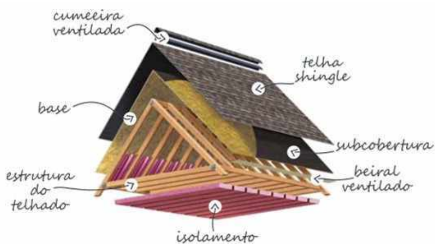
Figura 11: Revestimento de cobertura com telha do tipo shingle
