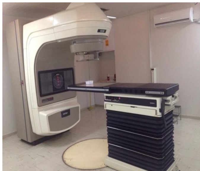
Figura 2: Irradiação das amostras com o acelerador linear Clinac 600C Varian®.
