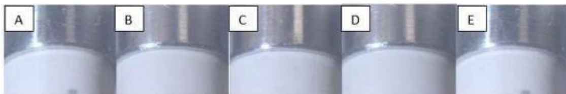
Figura 3 – Adaptação marginal dos transferentes confeccionados em PEEK após diferentes ciclos de esterilização (T0 a T4).
