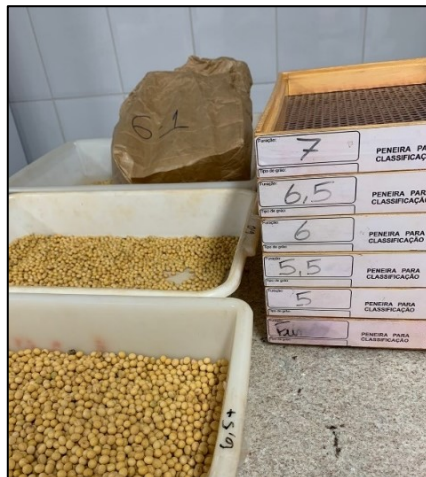
Figura 5. Peneiras utilizadas na seleção de sementes de soja. Fonte: Acervo pessoal.
