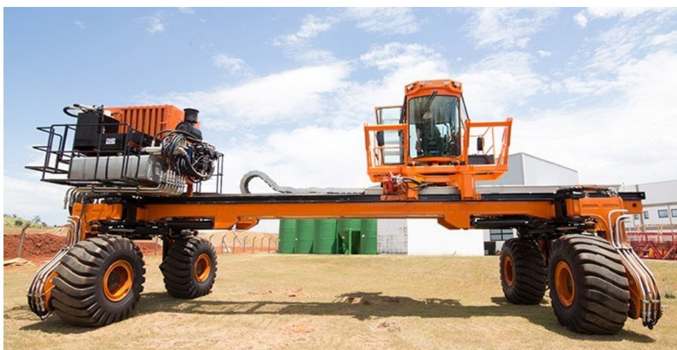
Figura 2.12 – Protótipo ETC (estrutura de tráfego controlado) (CTBE, 2014).
