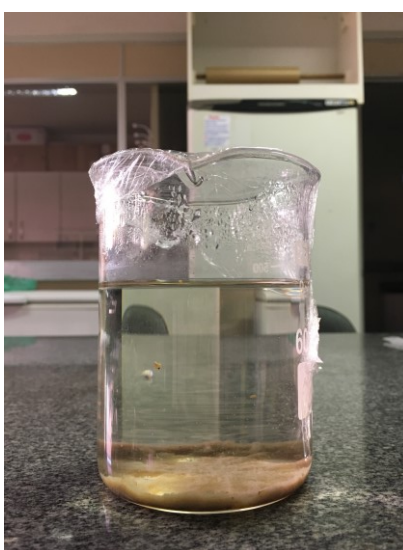
Figura 4.2 - Efluente após o tratamento pelo Processo Foto – Fenton
