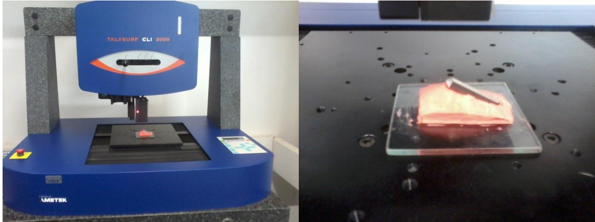
Figura 3.11 – Interferômetro (à esquerda) e penetrador sendo medido (à direita)
