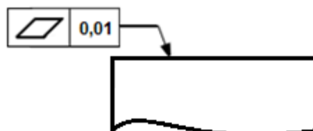
Figura 2.12 – Indicação de tolerância de planicidade (ABNT NBR 6409, 1997)
