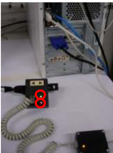
Figura 6. 18 - Gravador e tomada de energia: gravando restrição (led verde acesso)e sendo cumprida restrição(led vermelho acesso).
