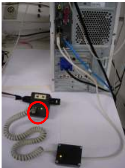
Figura 6. 17 – Gravador e tomada de energia: gravando restrição (led verde acesso).
