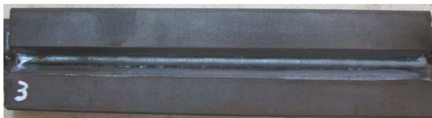
Figura 7.5 – Aspecto do cordão relativo ao ensaio 7.17 com destaque a excessiva convexidade.
