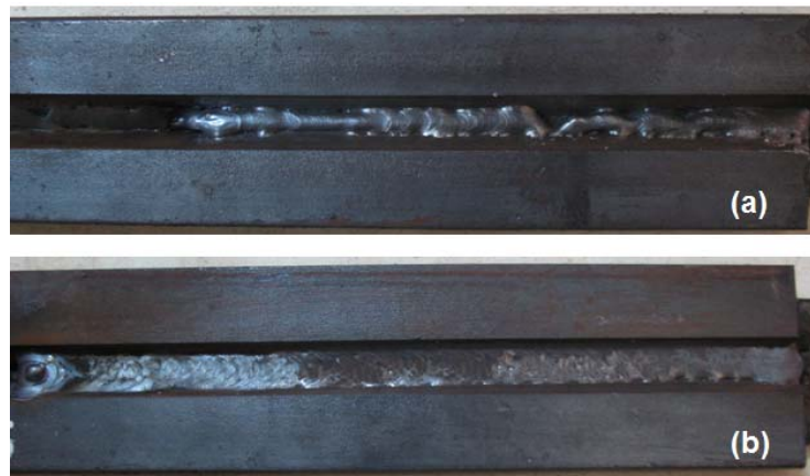
Figura 7.4 – Cordões com aspecto regular (a) e irregular (b) nas condições de MIG/MAG pulsado de Pereira (2000). Testes 7.15 e 7.19 respectivamente.
