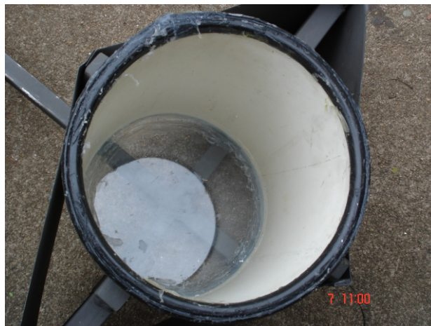
Figura 4.12. Tubo de pvc usado para construção da caixa estanque.
