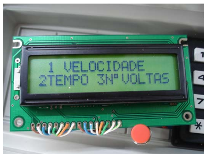
Figura 4.27. Display para visualização dos dados de treinamento.
