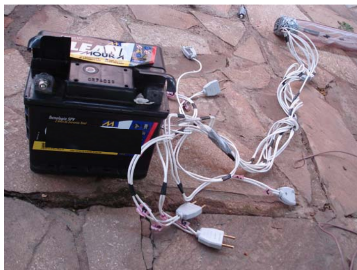
Figura 4.23. Fios e bateria automotiva usada para alimentação das lâmpadas e do circuito.
