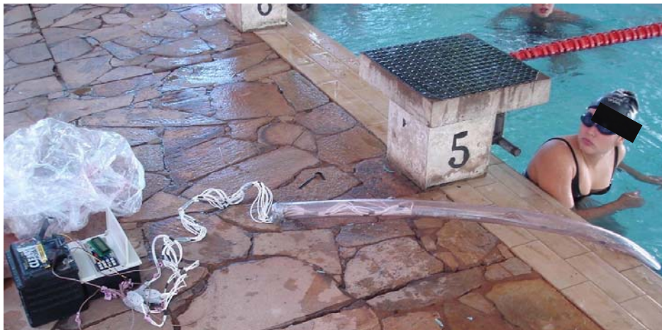
Figura 4.24. Fios saindo da mangueira até o circuito com a bateria.
