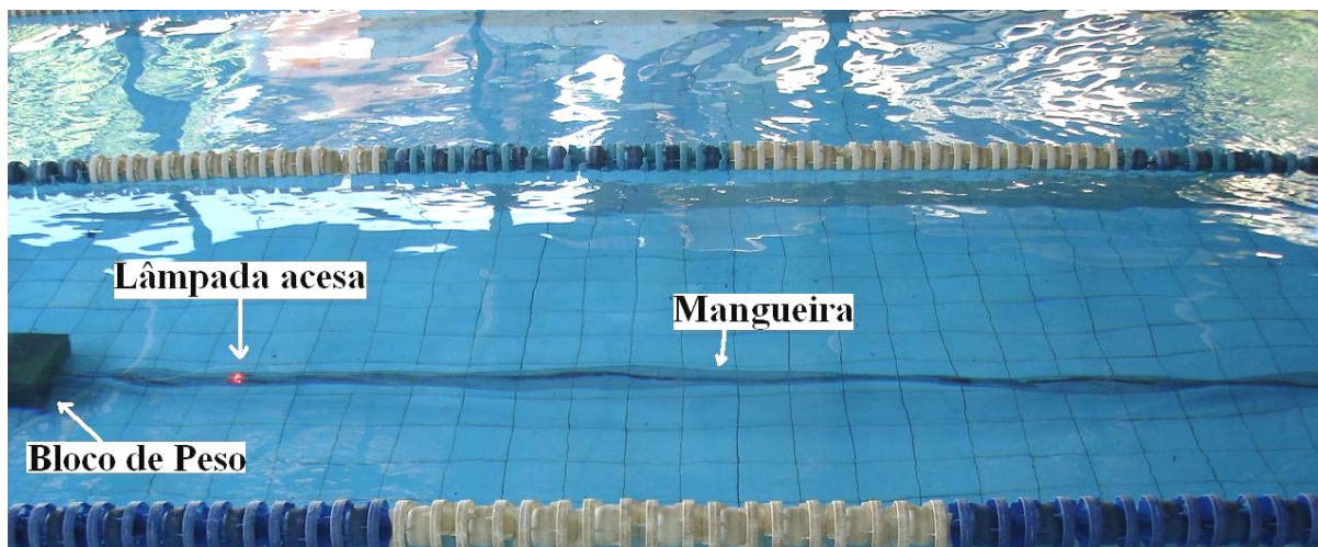
Figura 4.19. Sistema de estímulo visual em funcionamento.
