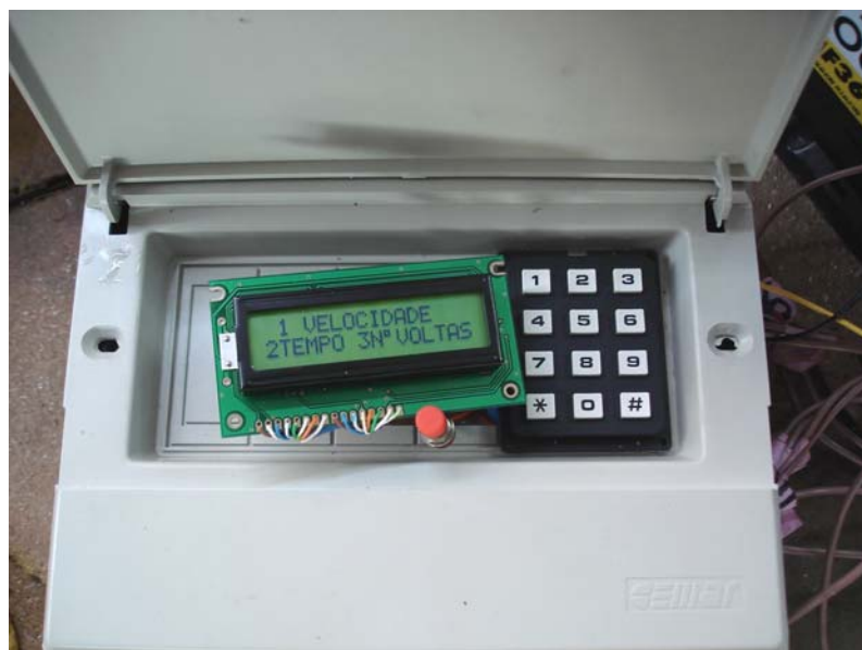
Figura 4.26. Display, teclado e botão reset.
