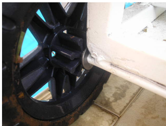
Figura 4.6. Foto do eixo soldado na estrutura e sem articulação.
