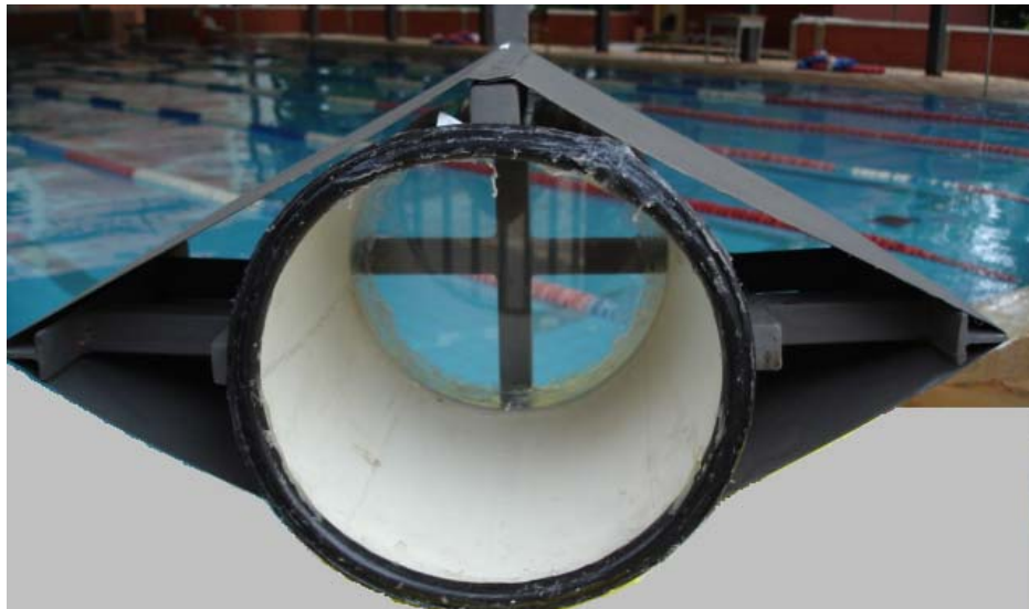
Figura 4.18. Estrutura ao redor da caixa, pontiaguda nas laterais para facilitar a passagem do fluxo da água.
