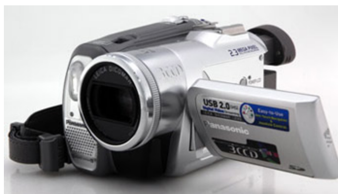
Figura 4.8. Filmadora Panasonic PV GS-150 com dimensões de 71mm de largura, 73mm de altura e 123mm de extensão.
