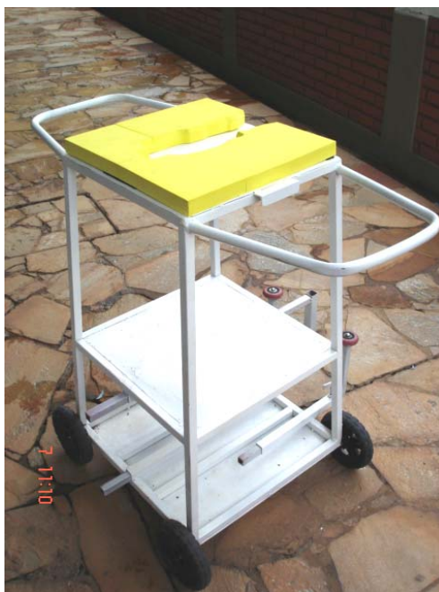
Figura 4.4. Foto do suporte demonstrando as bases e a estrutura de EVA na superior.
