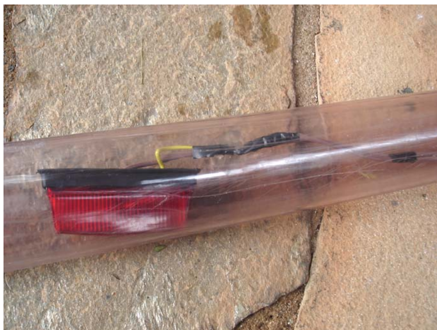
Figura 4.20. Lâmpada conectada aos fios por dentro da mangueira
