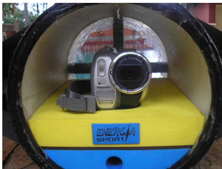
Figura 4.16. Suporte em EVA desenvolvido especialmente para encaixe da câmera
