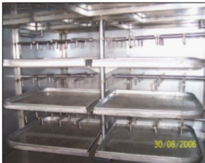
Figura 13. Secador de impacto em escala piloto mostrando bicos e bandejas de secagem.
