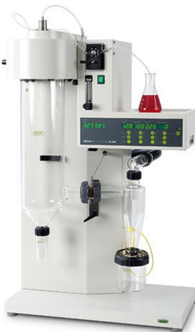
Figura 10. Mini Spray Dryer B-290 Büchi. Fonte: BUCHI (2019).
