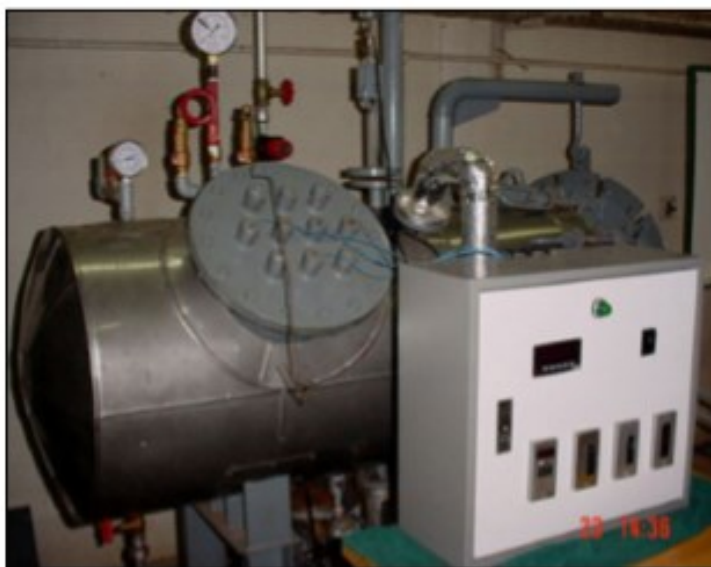
Figura 12. Secador por impacto de ar usado no experimento em escala de laboratório. Fonte: YAMSAENG SUNG & BUALUANG (2010).
