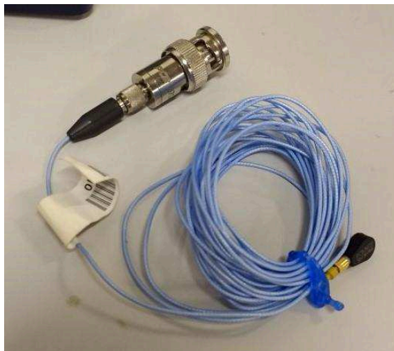
Figura 21: Acelerômetro e cabo de ligação ao condicionador de sinal
