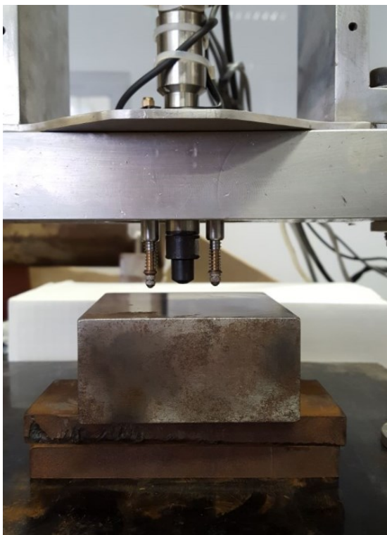
Figura 4.1 – Foto do ensaio com aço como corpo de prova.
