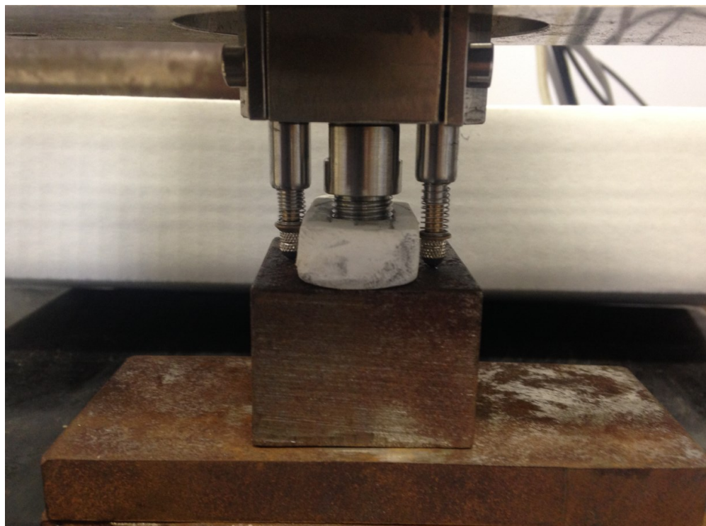
Figura 3.20 – Teste do usando borracha como corpo de prova, sem penetrador.
