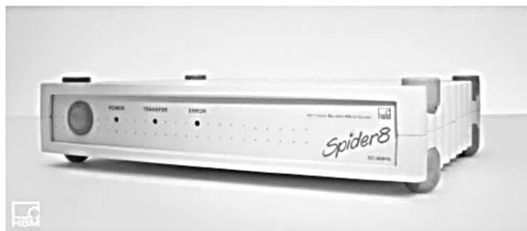
Figura 2.8 – Foto do equipamento Spider8® (HBM, 2017c)
