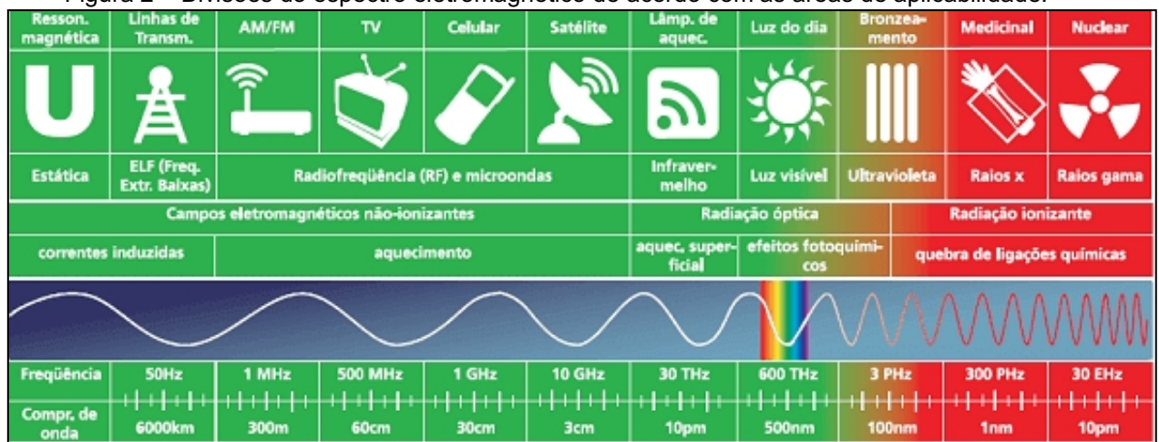
Figura 2 – Divisões do espectro eletromagnético de acordo com as áreas de aplicabilidade.
