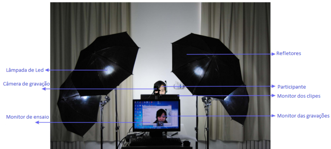
Figura 9 – Arranjo do aparato para aquisição dos cliques de microexpressões. Adaptado de (YAN et al., 2014)
