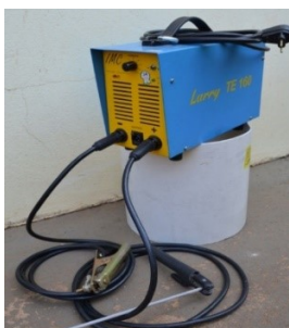
Figura 3.2 – Fonte usada para soldagem ER.
