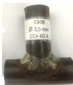
Figura 3.13 – Amostra soldada com eletrodo do tipo E308 com \varnothing 2,5 mm CC+ 60 A.
