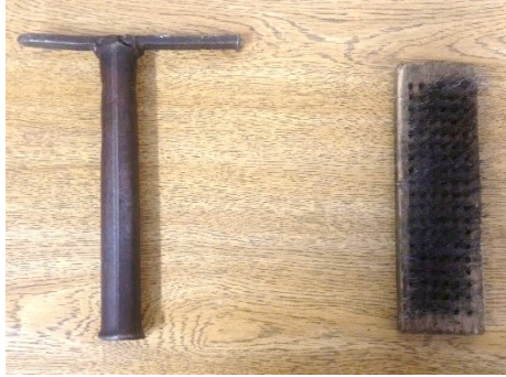
Figura 3.6 – Ferramentas para remoção de escórias (Escova de aço e Martelo Picador de Solda).
