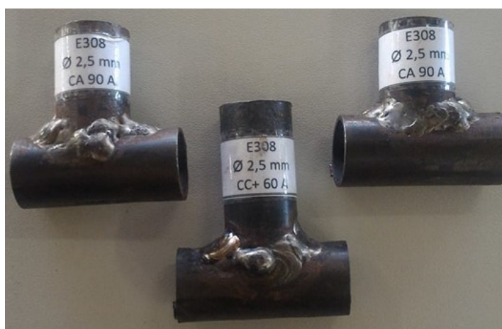
Figura 3.12 – Amostra soldada com eletrodo do tipo E308 com \varnothing 2,5 mm CA 90 A.
