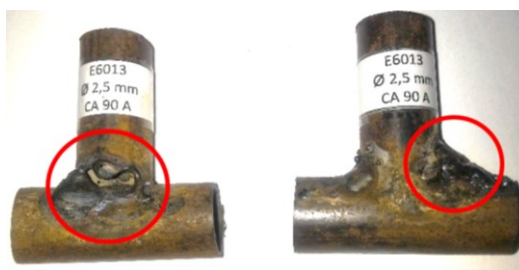
Figura 3.9 – Amostras soldadas com eletrodo do tipo E6013 com Ø 2,5 mm com defeitos sinalizados.
