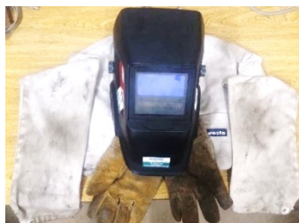
Figura 3.5 – Equipamento de proteção (Luvas, Blusão e Máscara de Solda).
