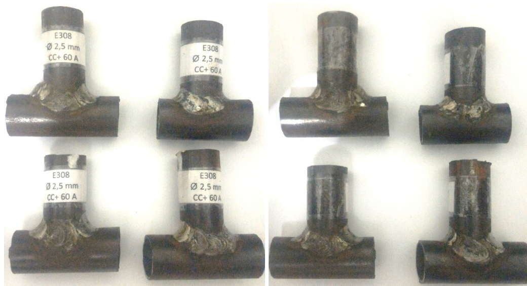
Figura 3.14 – Frente e costas das amostras de solda com eletrodo do tipo E308 com Ø 2,5 mm CC+ 60 A com qualidade semelhante.
