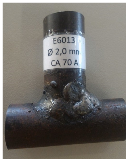
Figura 3.11 – Amostra soldada com eletrodo do tipo E6013 com Ø 2,0 mm CA 70 A.
