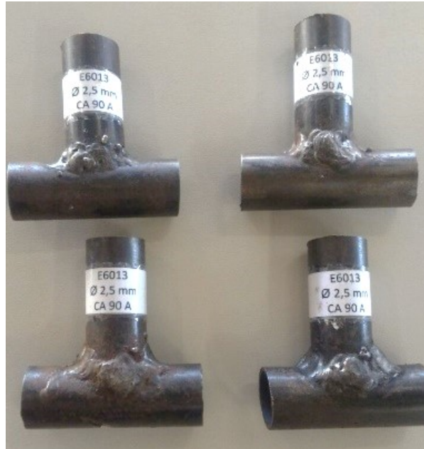
Figura 3.10 – Amostras soldadas com eletrodo do tipo E6013 com Ø 2,5 mm, CA 90 A, com respingos e descontinuidades.
