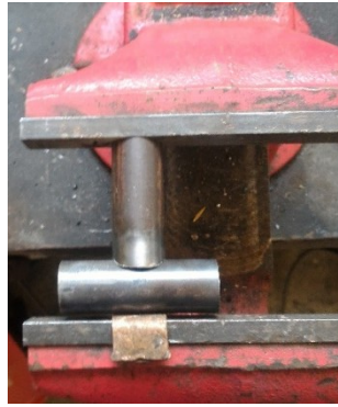
Figura 3.8 – Tubos com junta em “T” com “boca de lobo” e lixados, prontos para soldagem.
