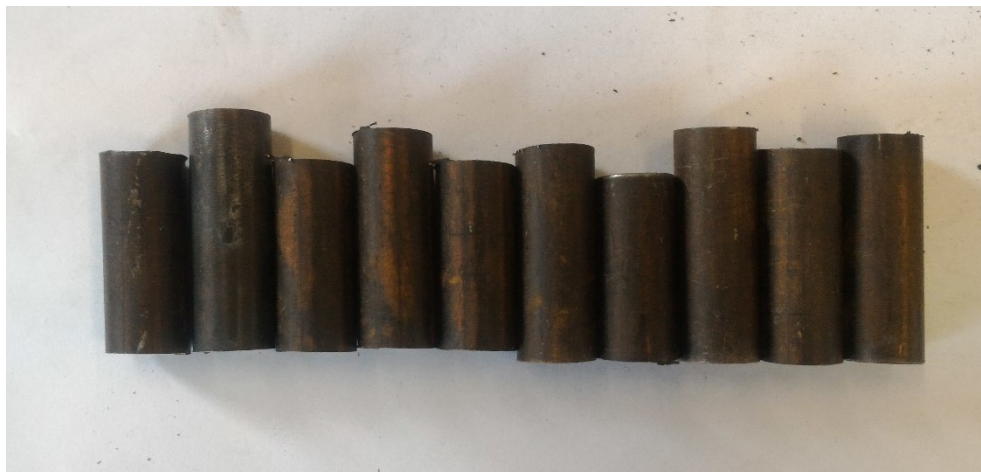
Figura 3.7 – Tubos de parede fina utilizados nas soldagens.
