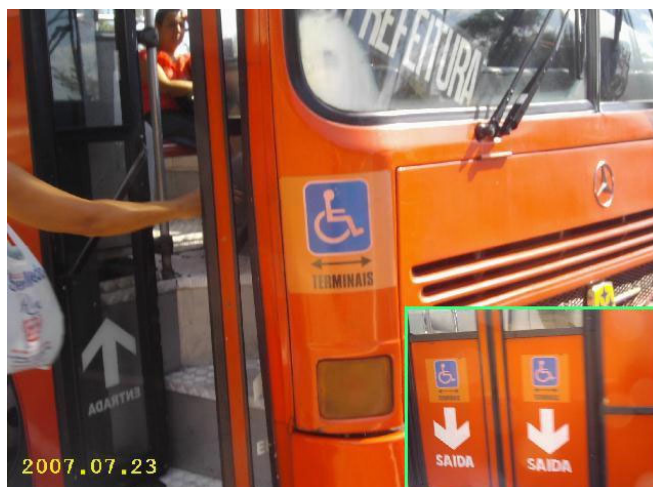
Figura 11 – Programação visual em ônibus adequado ao uso de plataforma elevatória estacionária dos terminais – Uberlândia, MG – 2007
