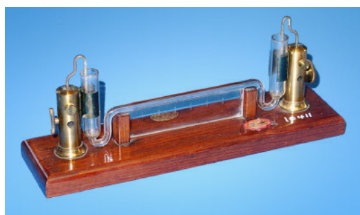
Figura 3.2 – Galvanômetro "Eletrodo Capilar" de Lippmann utilizado por Einthoven. [52]
