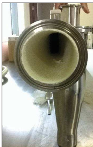
Figura 6 - Problema de deposição de pó no sistema que conecta a câmara de secagem ao ciclone
