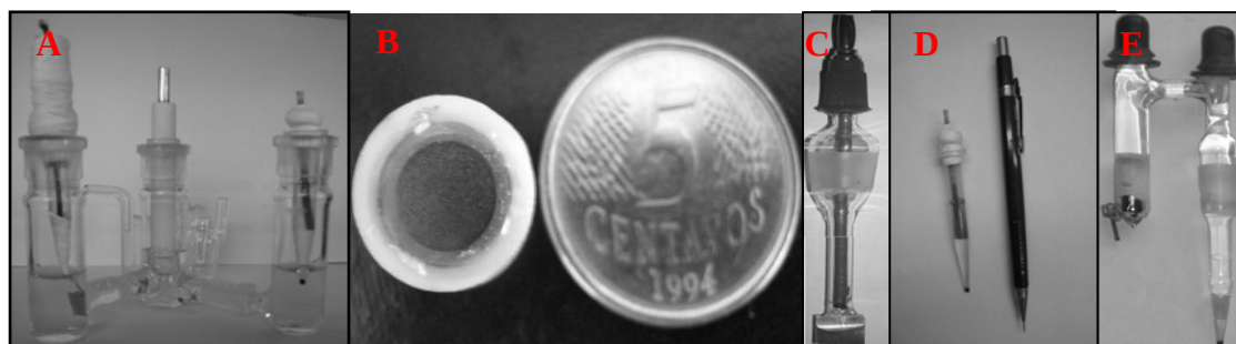
Figura 19 – (A) célula eletroquímica; (B) eletrodo de trabalho de carbono grafite na base de teflon, à esquerda da moeda; (C) eletrodo auxiliar de platina; eletrodo de referência de (D) prata/cloreto de prata, à esquerda de uma lapiseira, e de (E) calomelano.
