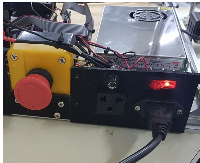
Figura 25 - Fonte, módulo de força e botão de emergência
