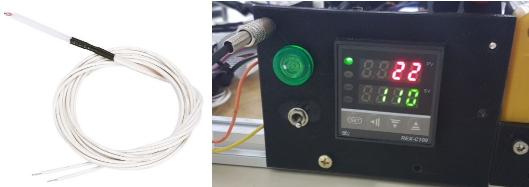
Figura 24 - Termistor (a) e módulo de controle da mesa com PT100 (b)
