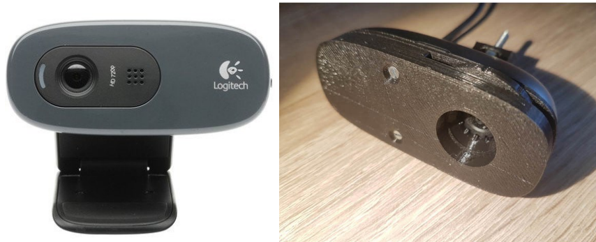
Figura 35 - Webcam C270 (a) e adaptação para ajuste de foco (b)
