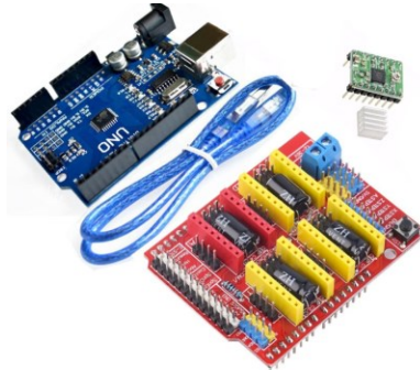
Figura 33 - Arduino UNO, placa de extensão CNC e driver
