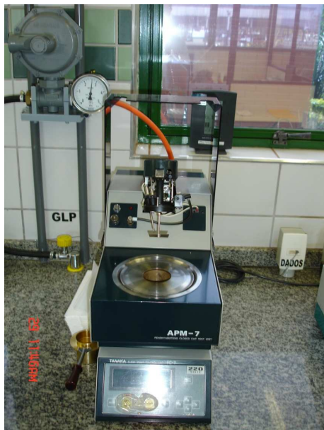
Figura 21. Analisador de ponto de fulgor automático utilizado para determinação de ponto de fulgor nos biodíeseis metílicos e etílicos.
