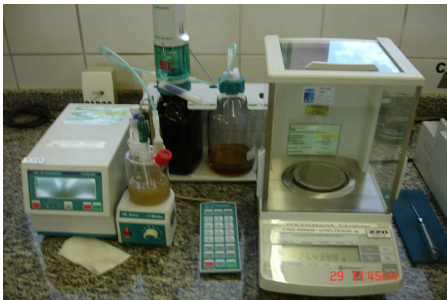
Figura 18. Aparelho de Karl Fischer utilizado para determinação de água nos óleos e biodíeseis.
