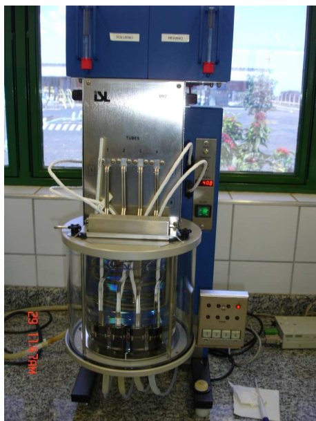
Figura 20. Analisador de viscosidade automático utilizado para determinação de viscosidade nos óleos e biodíeseis.
