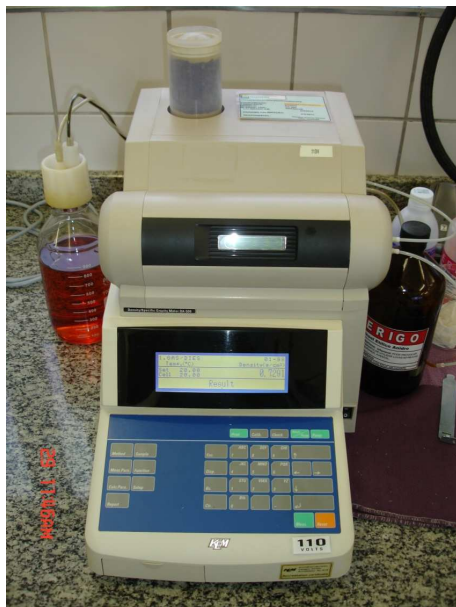
Figura 19. Analisador de densidade automático utilizado para determinação de densidade nos óleos e biodíeseis.
