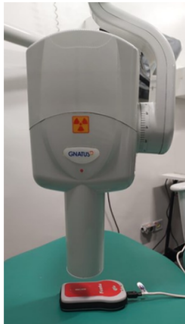
Figura 3.12: Posicionamento do detector RED PIRANHA. Figura de autoria própria.
