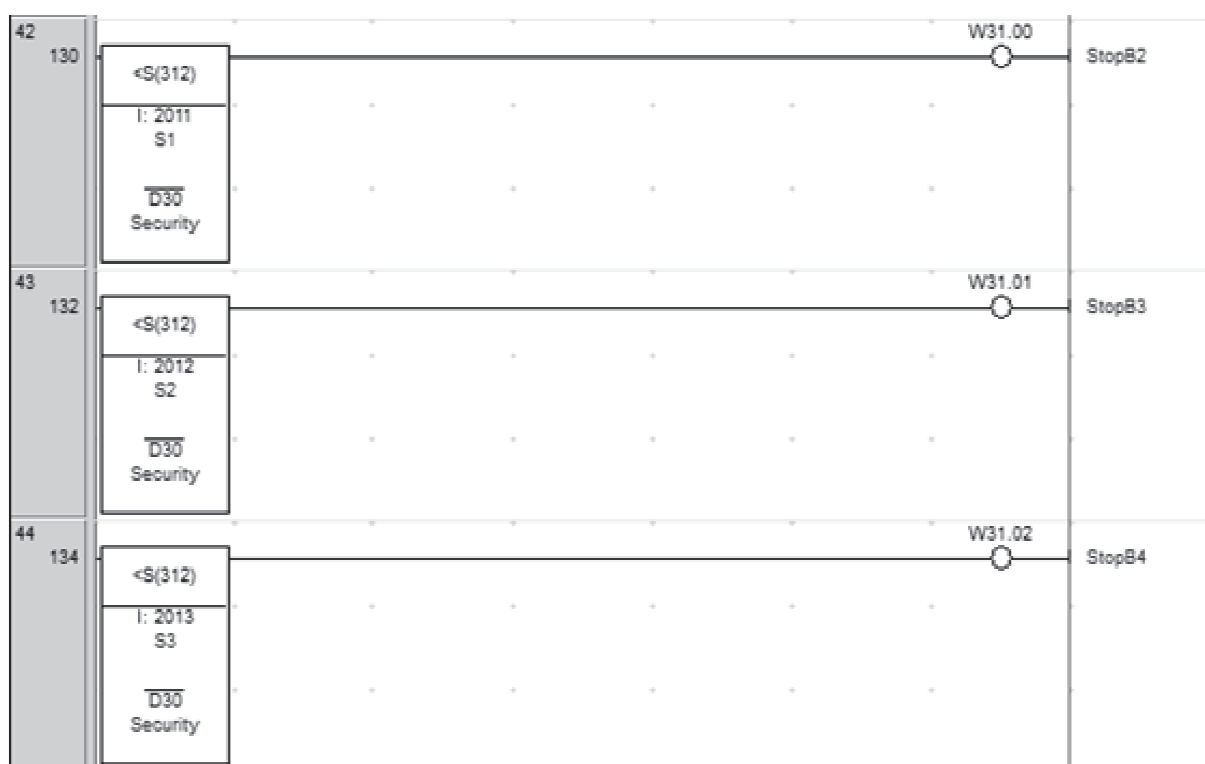
Figura 4.14. Intertravamentos para níveis de segurança.
