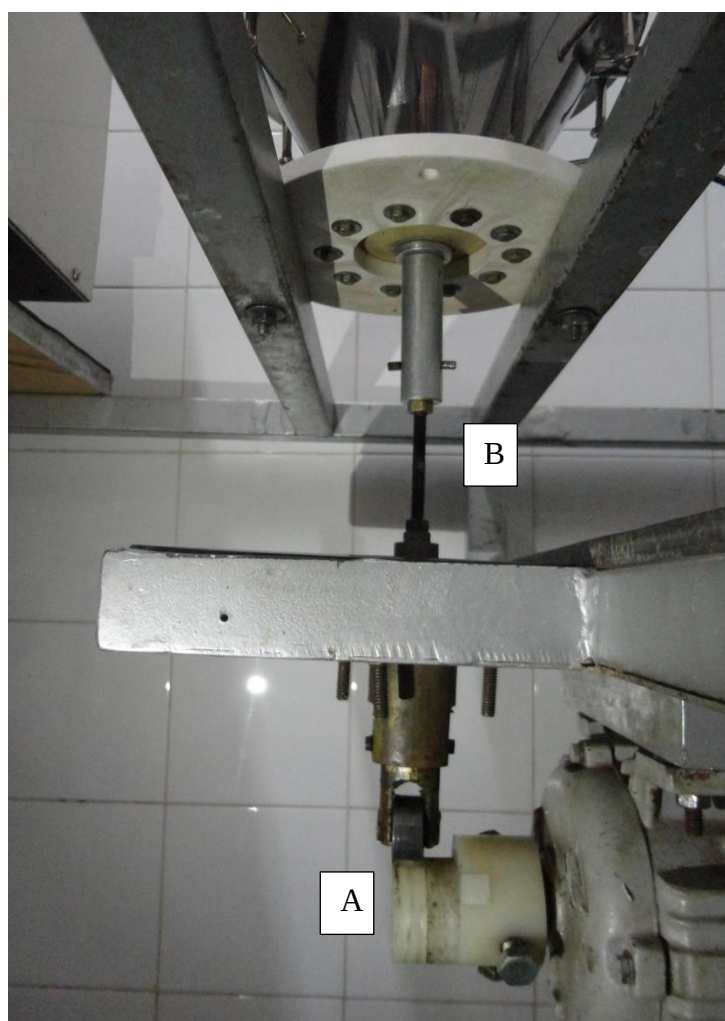
Figura 3.2 – Equipamentos do sistema de agitação: eixo vibratório (A) e excêntrico (B).
