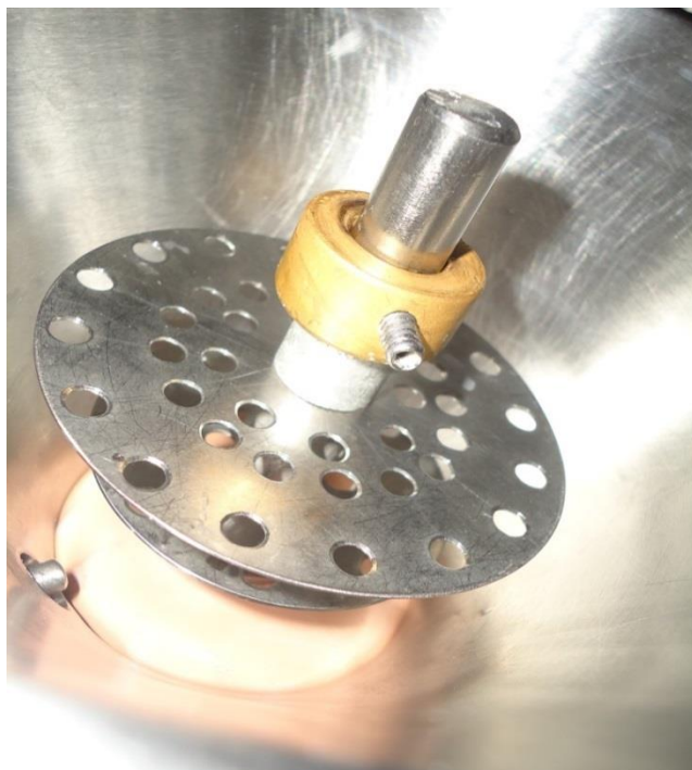
Figura 3.5 – Sistema de agitação da solução no cristalizador batelada.
