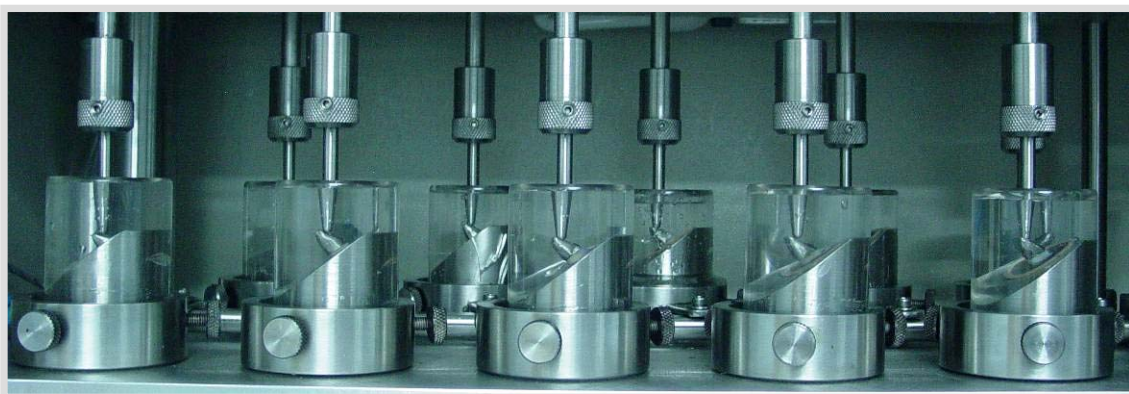
Figura 9. Amostras posicionadas na máquina de simulação de fadiga mecânica.
