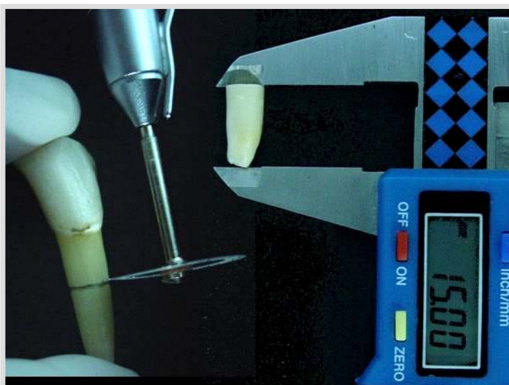
Figura 1. Seccionamento dentário e obtenção de raiz com 15 mm de extensão.
