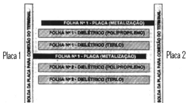
Figura 3.3- Capacitor com tecnologia não PPM.
