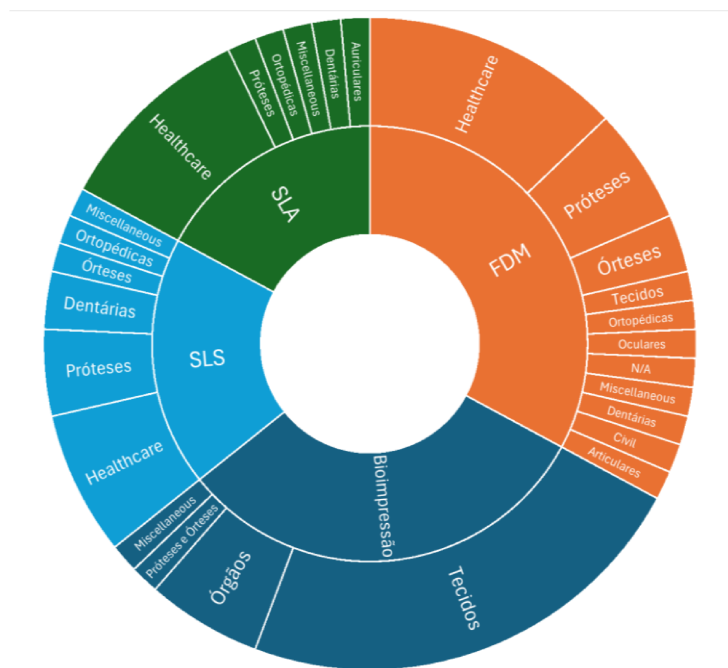
Figura 21 – Tipos de impressão e suas aplicações
