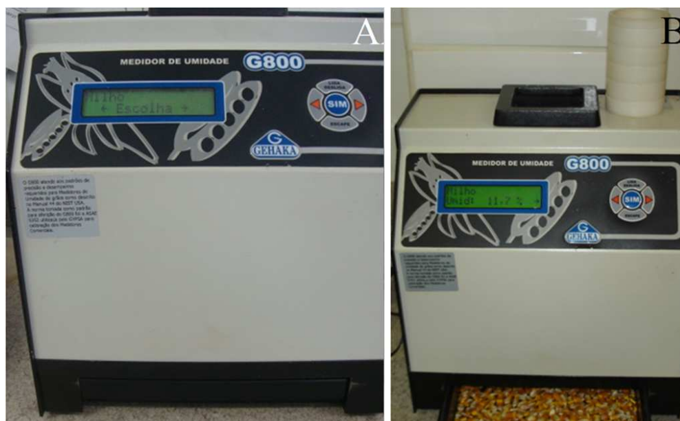
FIGURA 5 – A) Equipamento Geole 800 usado para determinar o grau de umidade; B) detalhe do equipamento mostrando o visor com o valor da umidade em porcentagem e as sementes no coletor, na base do equipamento após determinação
