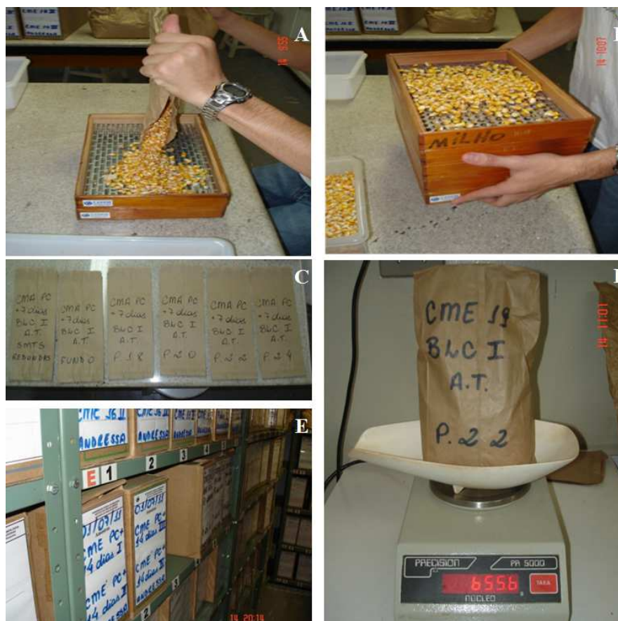
FIGURA 8 – A) Classificação na peneira 13 x 3/4; B) classificação nas peneiras 18, 20, 22 e 24; C) sacos de papel identificados para cada fase da classificação; D) sementes de cada peneira; D) armazenamento dos tratamentos em câmara fria (E)
