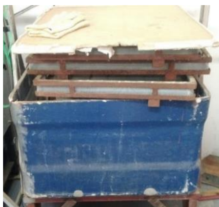
Figura 3.1 – Sistema para reumidificação das sementes. Fonte: O autor (2020).
